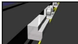
Wir liefern 2 verschiedene Füllstücke mit. Die Plexiglas-Variante ist zur Unterstützung von nicht angetriebenen Achsen. Sollte das Modell den Strom an einer solchen abnehmen, so benutze die vernickelten Füllstücke.
